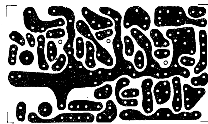
Fig 4. Mottagarens kretskort sett från foliesidan i skala 1:1.
