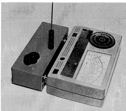
Fig 2. Fältstyrkemeter utförd som en plug-in-enhet till ett vanligt universalinstrument.
